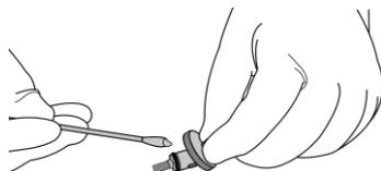
3. Aligner l'adaptateur dans le compartiment de la poignée, et l'insérer correctement.
