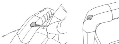
2. Préparer l'adaptateur en graissant légèrement le joint torique.
